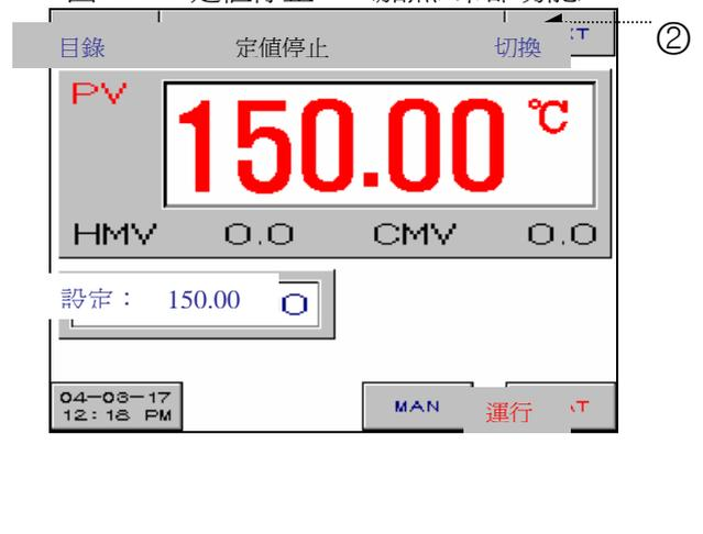
圖 2-16. 定值停止 - 定值運行時間結束時
