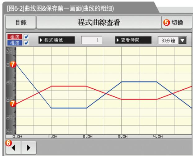
① 在当前进行中的曲线图中按被选择的  键、曲线图画面中的温度(红色)会消失、重新按  键、曲线图画面中表示出温度(红色)。
