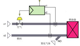
在这个例子中控制器会将过程值和设定值之间的比例关系显示出来而不会显示绝对的直 接数值, 当在此应用中的化学试剂比例刚好正确的时候仪表中会显示 1.00
