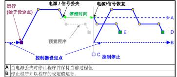
停止程序并将输出关闭 – *设定点显示值显示"OFF*"
