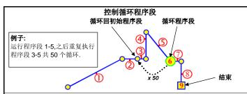
循环程序会跳转回到一个特定的程序段,这个动作会重复需要的次数(1到 9999)在程序 继续运行之前,至少1个循环程序段可以选择,但是每个被选择的程序段不能有交叉的 现象发生
