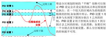
证 PID 设定会在设定值的高点和过程值附 近执行,在一个较大的区域内为系统提供 精准的控制.如如图中所示,PID 设置 1 用 来参与从刻度下限到分割点1之间的控 制, PID 设置 2 用干控制从分割占 1 到分 割点 2 之间的控制,以此类推,如果任何 一个分割点没有被设置,那么分区域规划 的控制就不可用.
