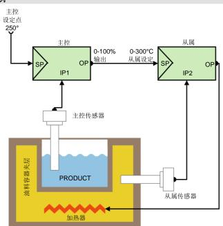
在这个例子中被控执行器是一个加热器,通过对油料夹层的加热间接地对产品进行加 热,从属系统的输入上限被限定为 300°C, 在控制系统启动时主控程序会比较当前的温 度和设定点之间的差值,然后提供100%的输出,这个输出对应从属控制中的最大设定 点(300°C)
